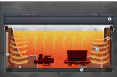
5-stufiges „**Platinum-Lock**“ **Vollschaum-Isoliersystem** - basierend auf jahrzehntelang bewährter Kühlschranks-Isolations-Technologie:
