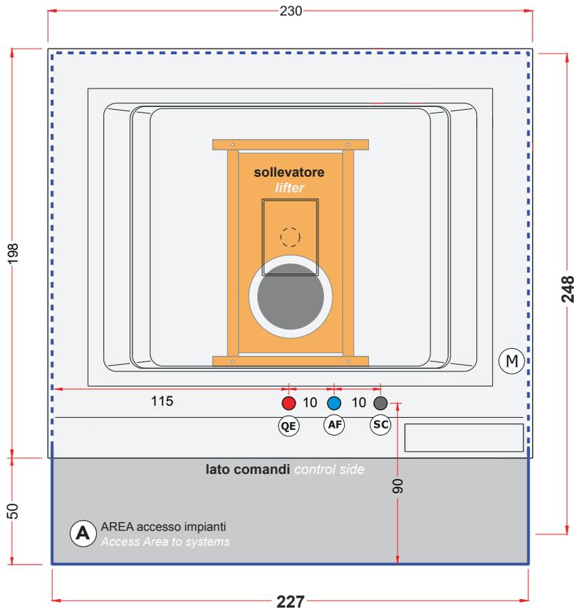
PROVVEDERE AL FISSAGGIO A TERRA DEL SOLLEVATORE SOLO DOPO AVER VERIFICATO LA CORRETTA ESCURSIONE DELLA VASCA.
