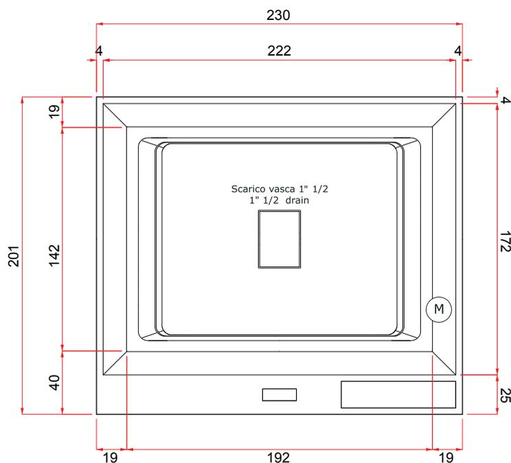
Motore Idromassaggio (M) Whirlpool Motor
