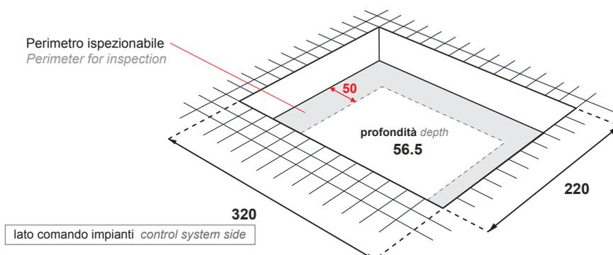
In caso di installazione ad incasso è necessario garantire una corretta aerazione con due griglie min. Ø15cm.
