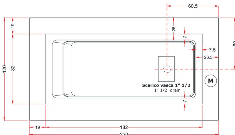
Motore Idromassaggio (M) Whirlpool Engine
