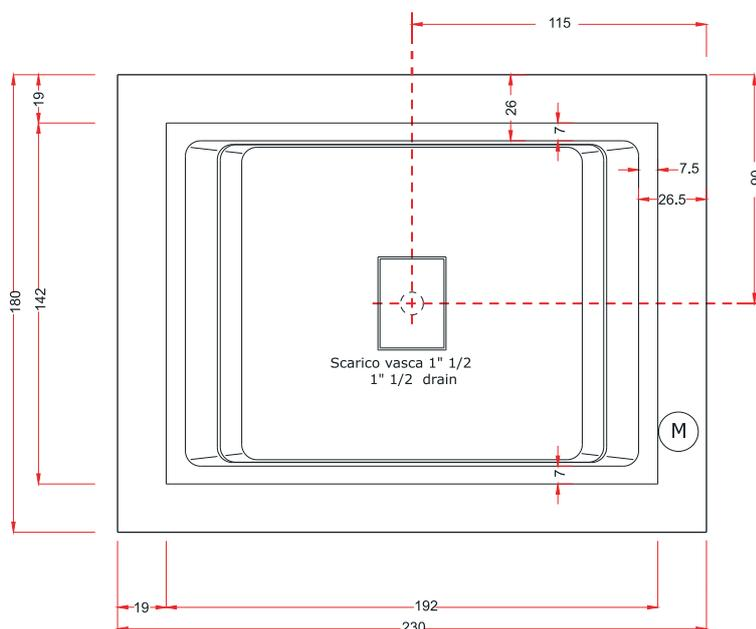
Motore Idromassaggio (M) Whirlpool Motor
